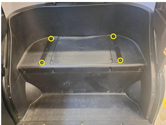
Irrota velcro tarranauhojen reunimmaiset kiinnitysruuvit. (ristipäämeisseli ph2).
