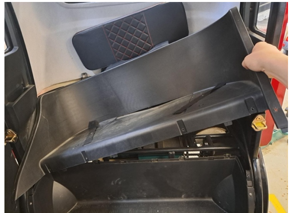
Nosta takaistuimen runko osa pois.
