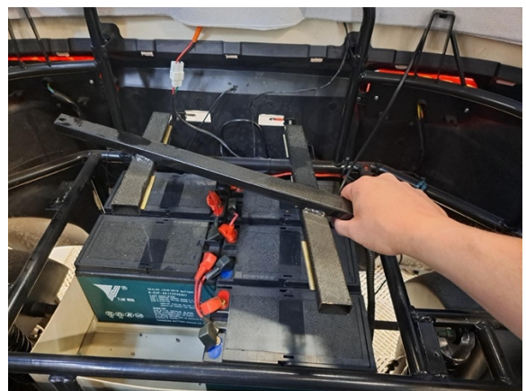
Nosta akkujen kiinnikerauta pois.
