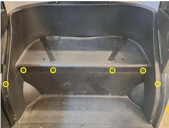
Irrota takaistuimen rungon kiinnitysruuvit. (ristipäämeisseli ph2).
