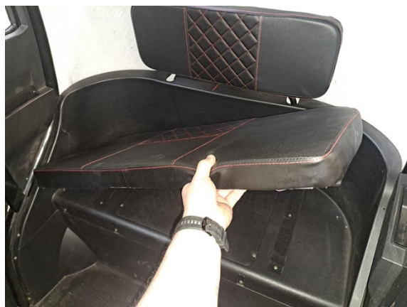
Nosta takaistuin pois. (tarrakiinnitys).
